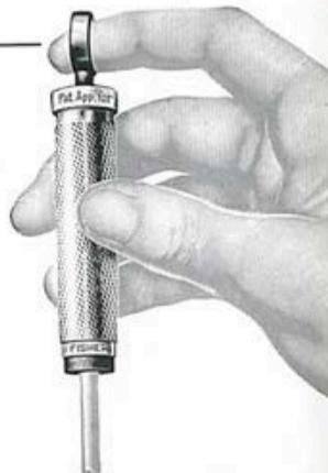
↑ THE FOREFINGER CONTROLS THE LIQUID LEVEL JUST AS IT WOULD IF IT WERE ON THE TOP OF THE PIPETTE . . . . .
